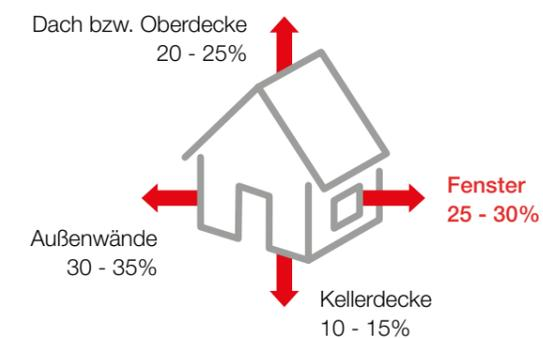
Abb.: Beispiel für Transmissionswärmeverluste bei einem durchschnittlichen Einfamilienhaus
